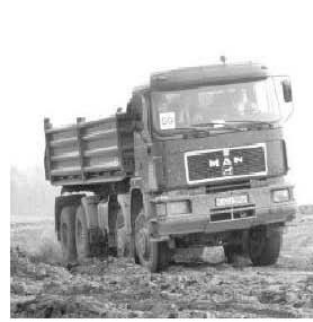
Bild 169: Links: Massgeblicher Lastfall für das primäre Tragsystem, rechts: schwere, kompakte Bautransporter sind aufgrund deren steifer Federung auch dynamisch gesehen die aggressivsten Fahrzeuge
