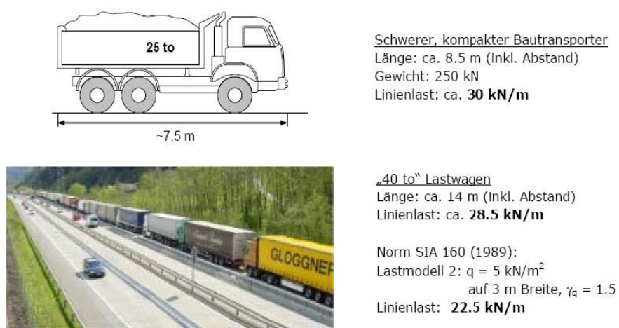
Bild 204: Verkehrslast infolge typischer Lastwagen
